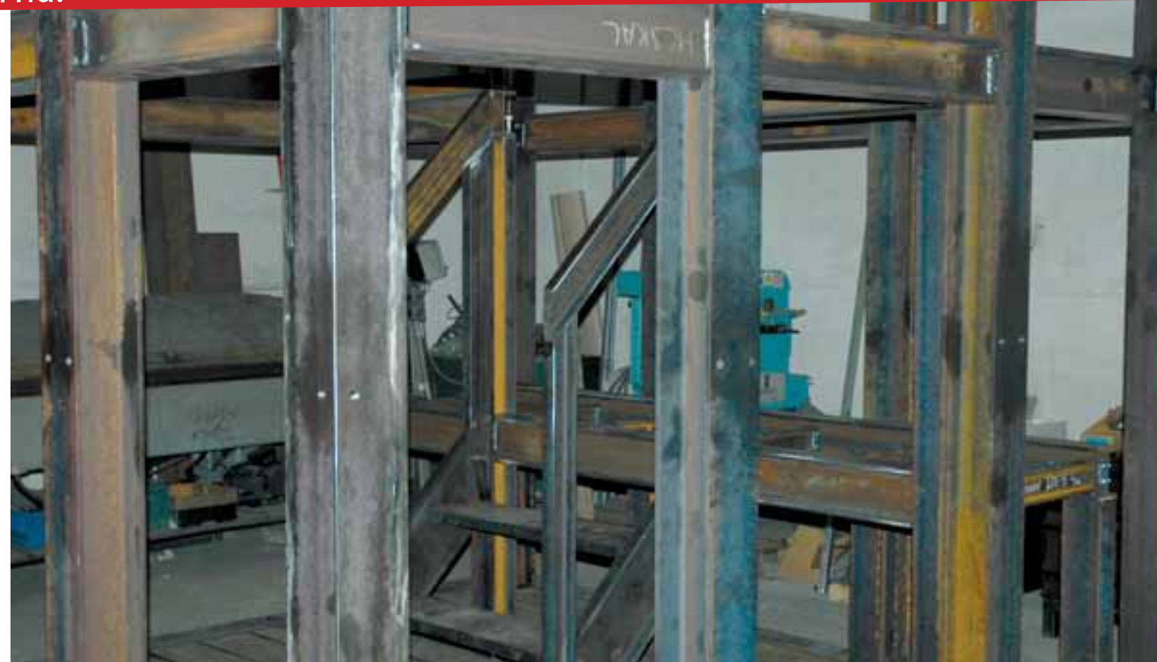
Pro kontrolu správného postupu byly konstrukce ve výrobě několikrát smontovány a rozebrány. Pohled do Domu matky s podestou a schůdky.
