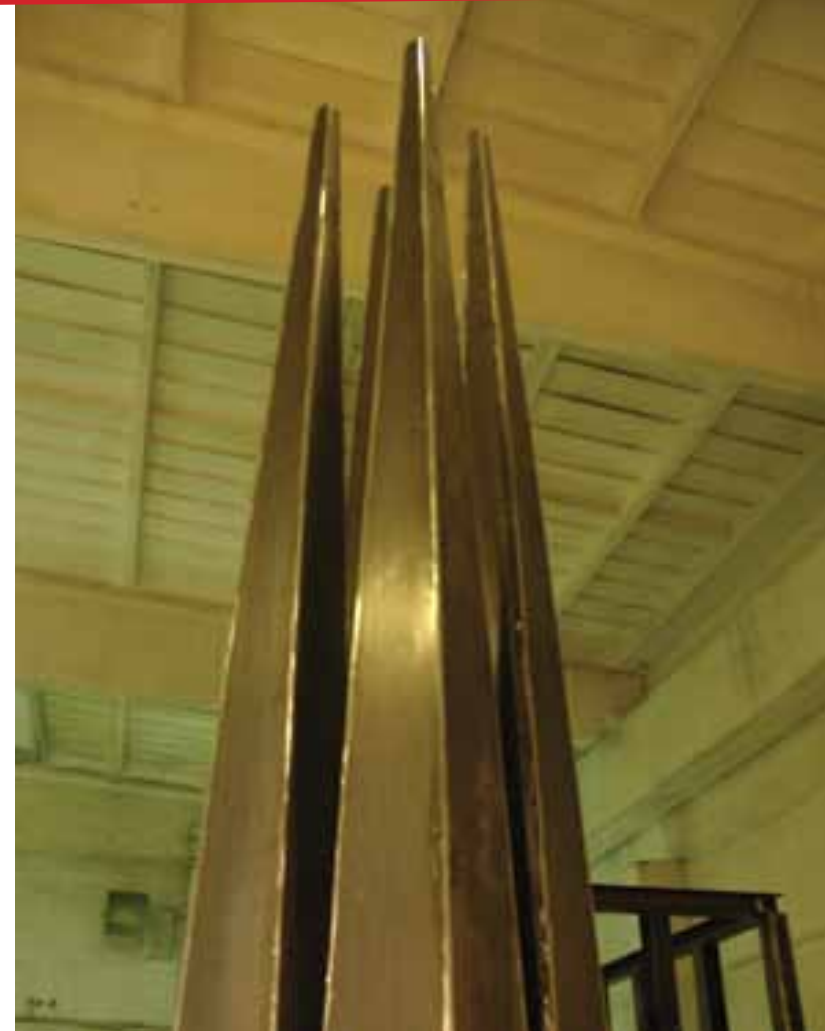
Železná vnitřní konstrukce byla pro konzervaci pozinkována, aby nepodléhala korozi. Zkoušky osazení trnů na rám a intenzita osvětlení mezi hroty.
