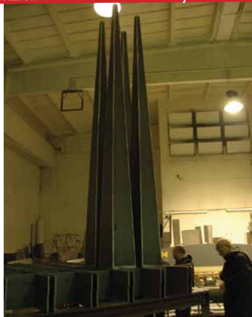
Železná vnitřní konstrukce byla pro konzervaci pozinkována, aby nepodléhala korozi. Zkoušky osazení trnů na rám a intenzita osvětlení mezi hroty.
