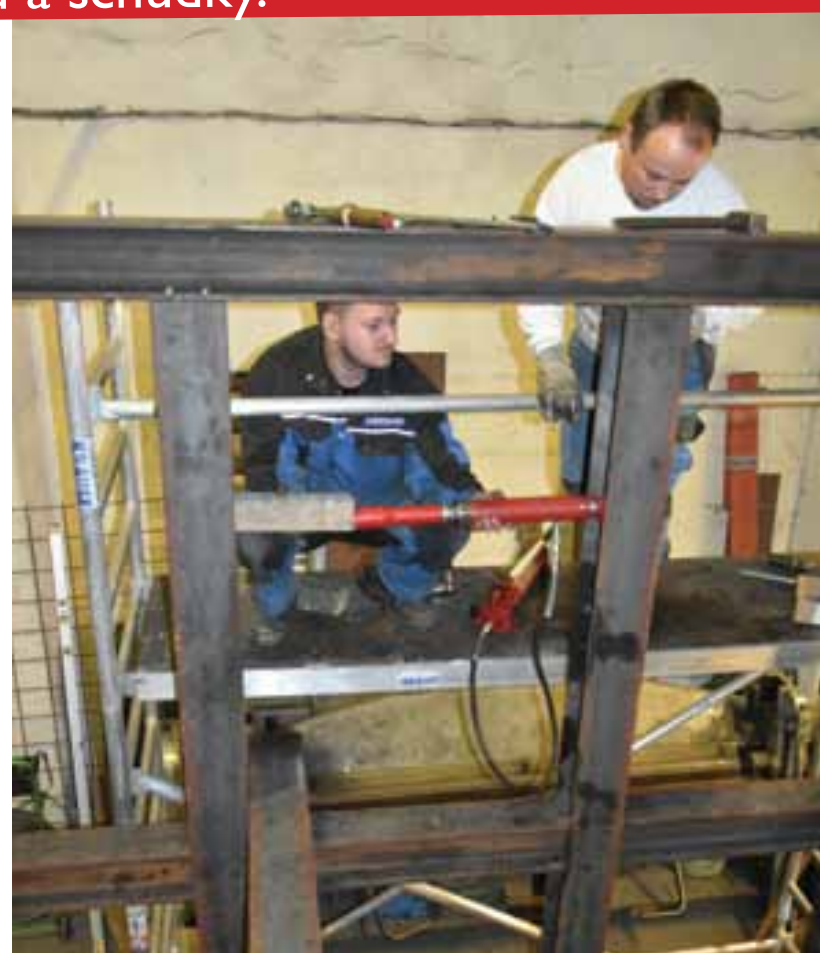
Železná vnitřní konstrukce byla pro konzervaci pozinkována, aby nepodléhala korozi. Zkoušky osazení trnů na rám a intenzita osvětlení mezi hroty.
