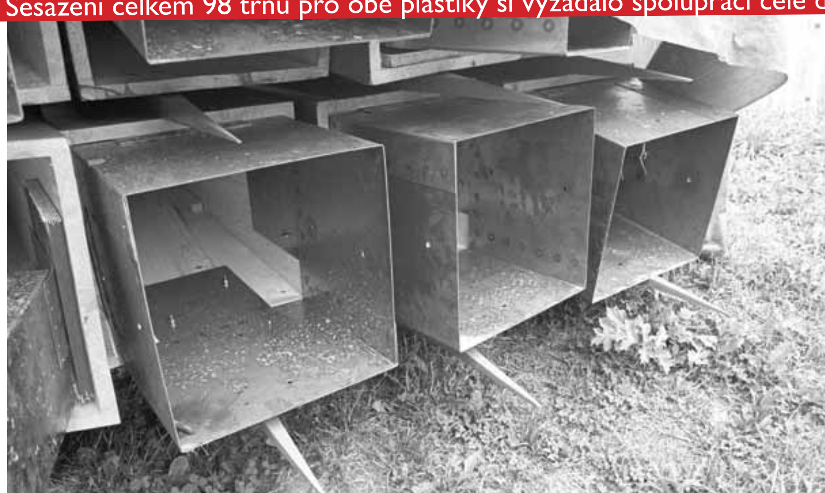
Jednotlivé trny byly zespodu opatřeny kovovými nástavci. Rám konstrukce se musel montovat venku před dílnou.
