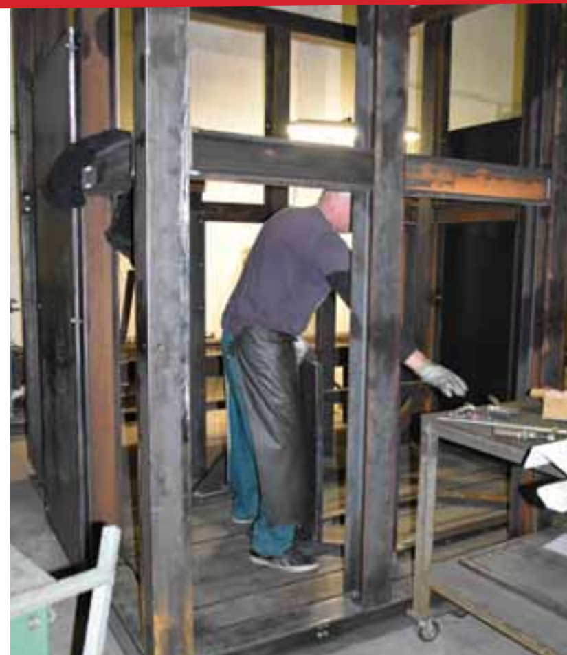
Železná vnitřní konstrukce byla pro konzervaci pozinkována, aby nepodléhala korozi. Zkoušky osazení trnů na rám a intenzita osvětlení mezi hroty.
