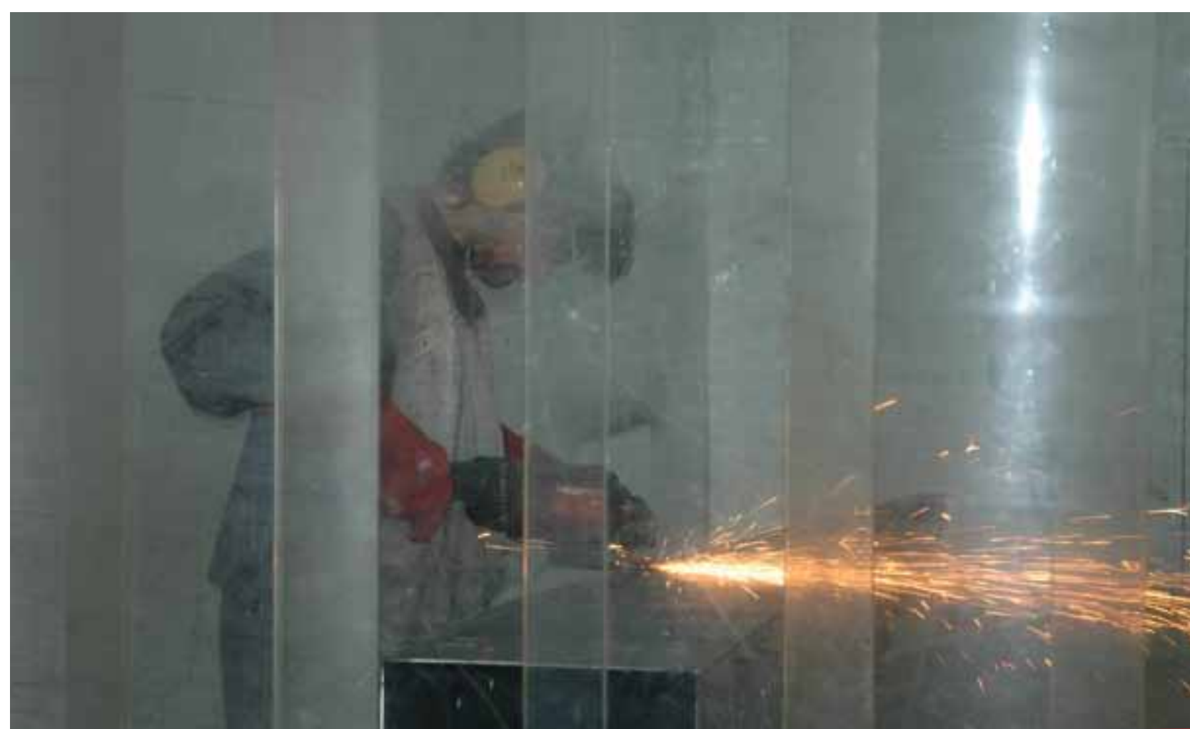
Svařování trnů v hale v Chotěboři. Trny Domu syna jsou dokonale ostré, vybroušené do ostrého hrotu. Toho šlo docílit pouze navařením plných nerezových špiček na vrchol trnu.
