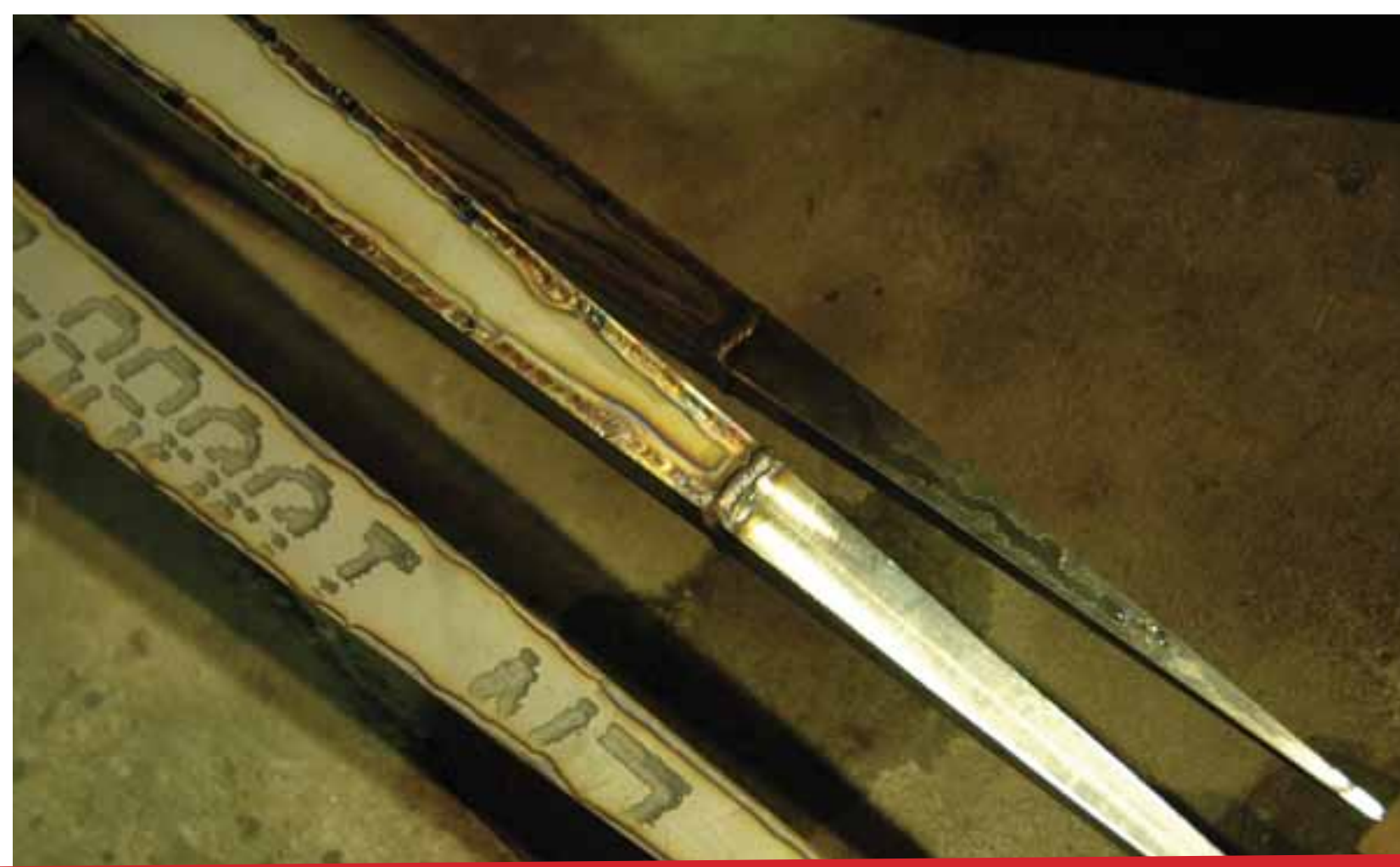
Svařování trnů v hale v Chotěboři. Trny Domu syna jsou dokonale ostré, vybroušené do ostrého hrotu. Toho šlo docílit pouze navařením plných nerezových špiček na vrchol trnu.
