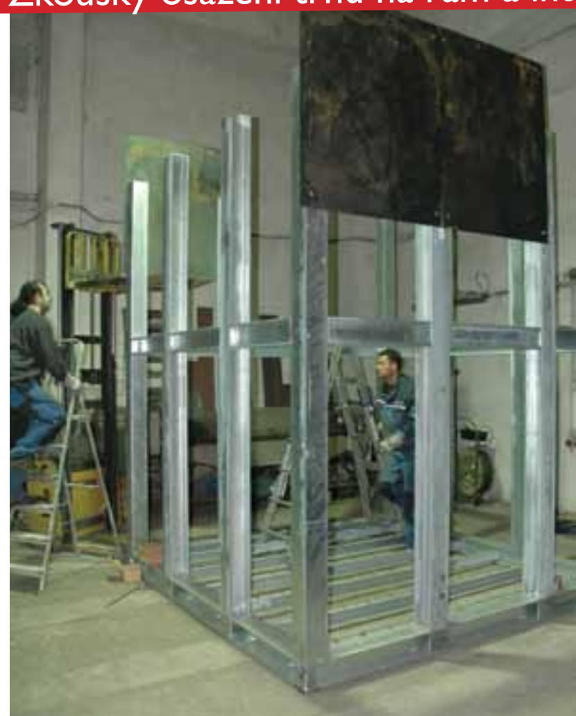
Železná vnitřní konstrukce byla pro konzervaci pozinkována, aby nepodléhala korozi. Zkoušky osazení trnů na rám a intenzita osvětlení mezi hroty.
